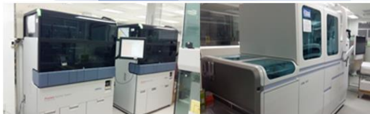
Kỹ thuật NAT được triển khai tại khoa Sàng lọc máu (1): Hệ thống Cobas 6800; (2): Hệ thống Procleix Panther
